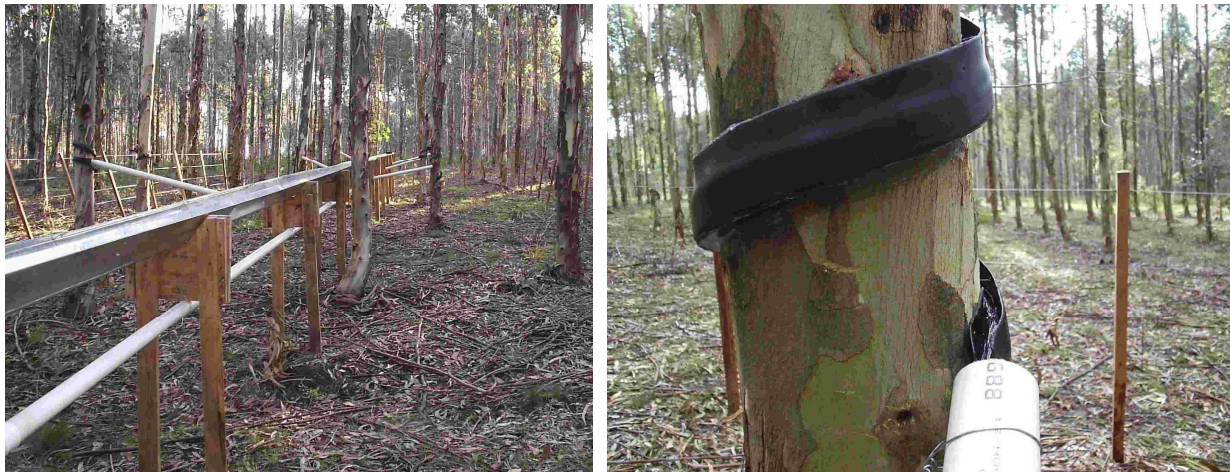
Figura 3.9 Instalaciones para el monitoreo de la precipitación directa y fustal
