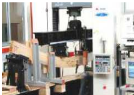
Figura 1.3. Ensayo en cuerpos de prueba: a) libre de defectos y de tamaño pequeño (Fuente: Wagner, 2015); y b) de tamaño estructural (Fuente: O'Neill et al, 2002)
